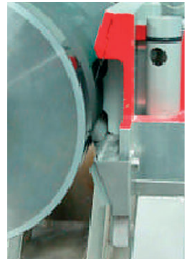
Teilansicht einer seitlich am Zylinder angebrachten Kammerrakel.
